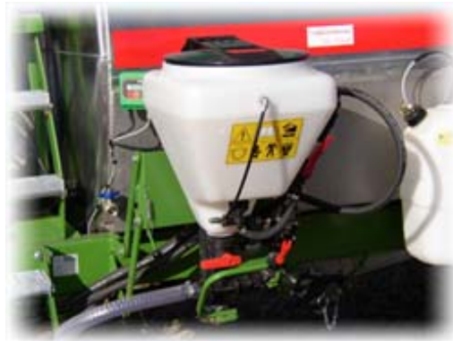
Preparatpåfyllare placerade på vänster- är justerbar i höjddled för optimal arbetshöjd.
