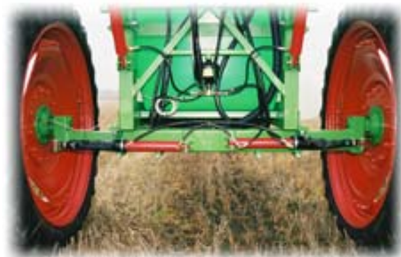
Hydraulisk inställning av spårvidd 150-225 cm
