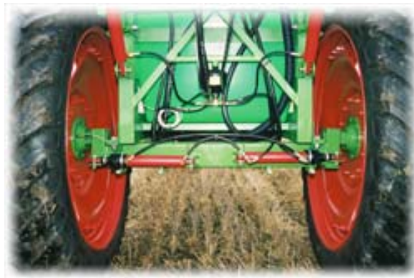
Hydraulisk inställning av spårvidd 150-225 cm
